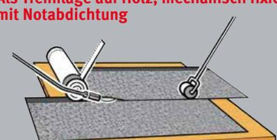
**Als Trennlage auf Holz, mechanisch fixiert, mit Notabdichtung**
