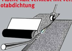
**In der Fläche kalt verklebt mit verschweißter Naht und Notabdichtung**
