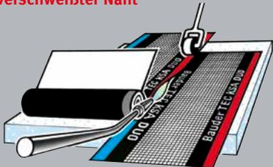
**In der Fläche kalt verklebt mit verschweißter Naht**
